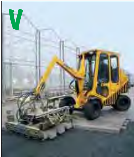
Machine met vacuümtang om een groot aantal straatstenen tegelijk te verplaatsen
