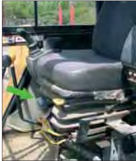
Verschillende soorten afstellingen van de stoel afhankelijk van het gewicht van de bestuurder
