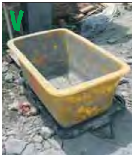
Mortelbak met bevestigingssysteem voor verplaatsing met kraan
