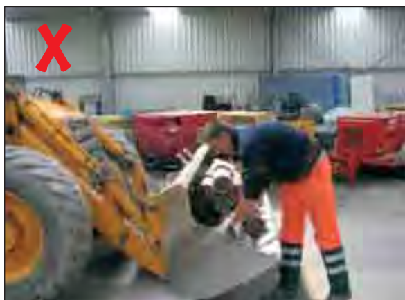
Kippak nog op grondniveau: de romp moet zich telkens buigen om het materiaal in te laden
