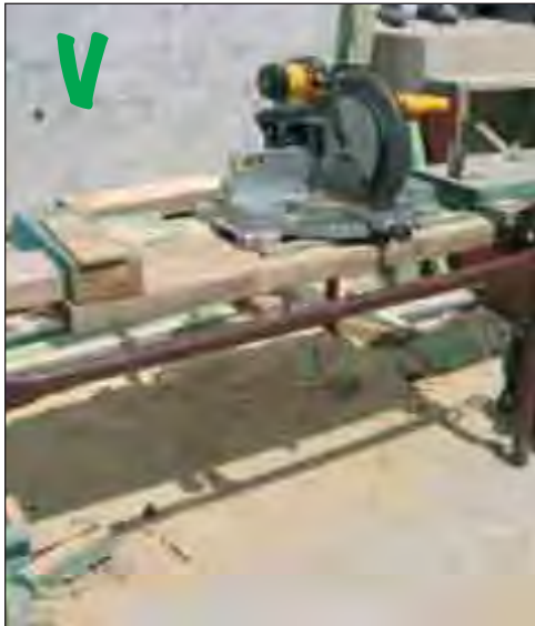
Draagbare zaag, bevestigd aan een werkbank, om te werken zonder bukken
