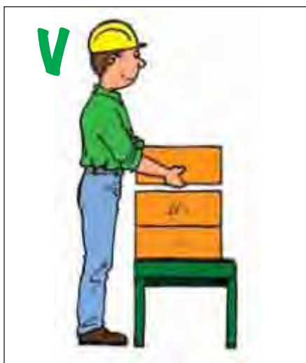
De lasten worden op een verhoog geplaatst: de rug wordt gespaard
