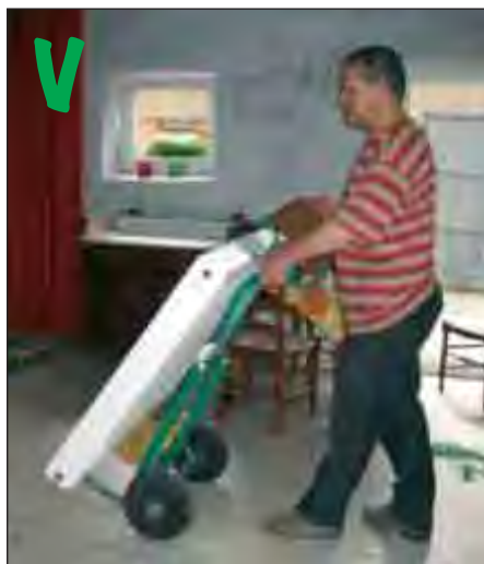
Wagentje om radiatoren en zware en omvangrijke lasten te verplaatsen
