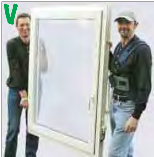
Singel voor het hanteren van raamwerk (Fabricius fastener)
