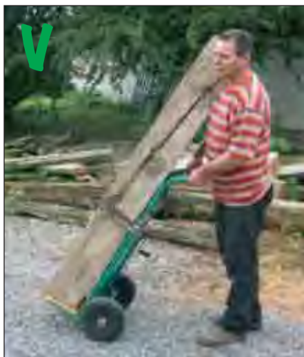
Wagentje om radiatoren en zware en omvangrijke lasten te verplaatsen
