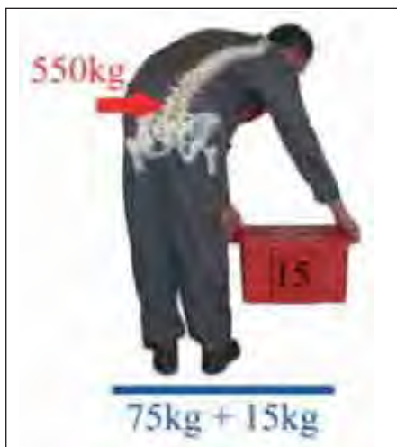
Zeer risicovolle houding voor de rug: voorovergebogen en zijwaarts gedraaid met een last in de handen
