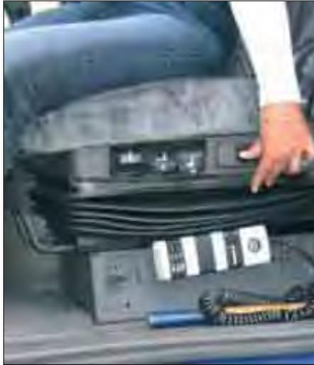
*Siège avec suspension pneumatique*
