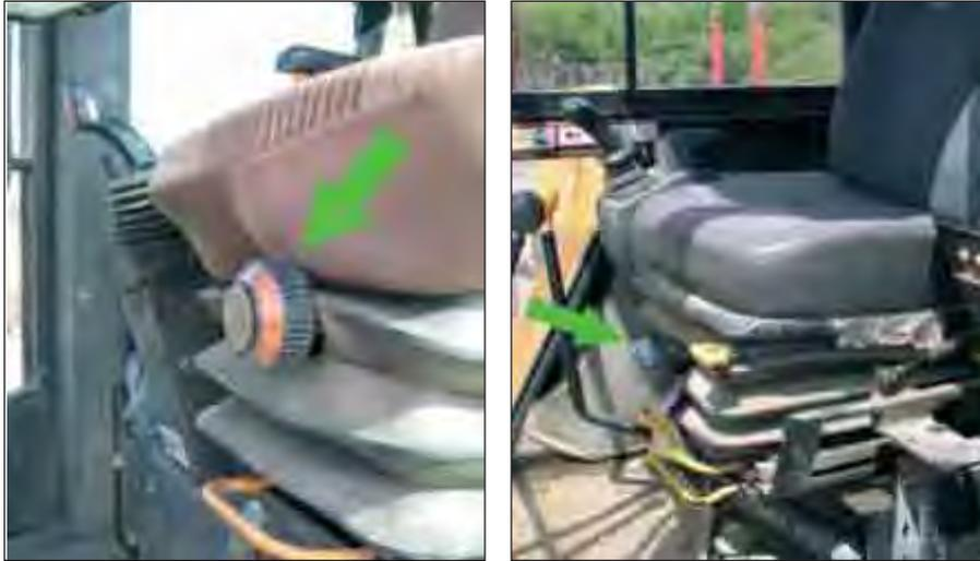
*Différents types de réglage du siège en fonction du poids du conducteur*
